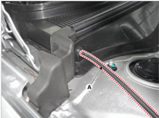
4. 拆卸夹，拆卸车颈顶盖(A)。
